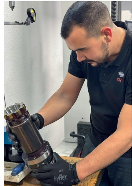
**3** Werkzeugeinsteller Agustín Calado von Mapal prüft die mit neuen Wendeschneidplatten bestückten Reibahle HPR400 für die Fertigbearbeitung der Kurbelwellenlagergasse am Motorblock © Mapal
